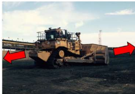
Foto 3. Identificación de la línea de fuego (flechas rojas) en los tractores de orugas. No está permitido estacionarse en la parte frontal o posterior del tractor de orugas, arranques repentinos del tractor pueden ocasionar incidentes. Se debe tanquear garantizando que el operador este fuera de cabina y en tierra
